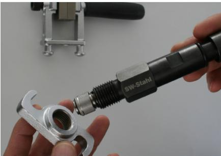
Lösen Sie jetzt die Spannschraube am Grundkörper (1) und entnehmen Sie die Klemmbacken, um die Bördelung zu kontrollieren.
