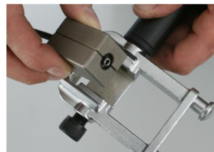
Verwenden Sie die Klemmbacken so, dass die gewünschte Bördelkante (90° bzw. 45°) entsteht.
