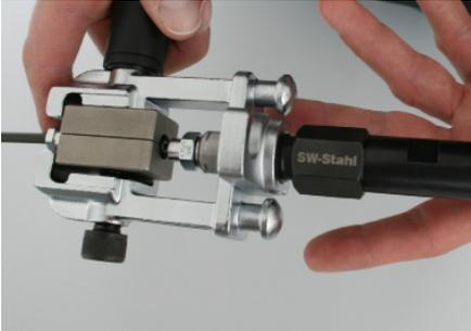
Verwenden Sie den Drehgriff (4) um die Druckspindel (3) zu betätigen und drehen diesen rechtsherum bis Sie einen Gegendruck spüren, um die Bördelung fertigzustellen.
