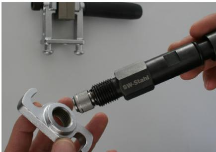
Drehen Sie nun die Gegendruckplatte (2) locker auf die Spindel.
