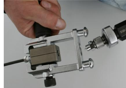
Nun schrauben Sie die Druckspindel (4) zusammen mit dem Druckstück in den Gegendruckkörper (2).
