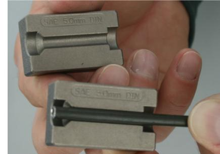
Retirez les mâchoires de serrage (5, 6 ou 7) correspondant au diamètre de la conduite de frein, placez la conduite de frein entre elles.
