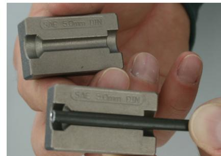
Entnehmen sie die dem Durchmesser der Bremsleitung entsprechenden Klemmbacken (5, 6, oder 7), legen die Bremsleitung dazwischen.
