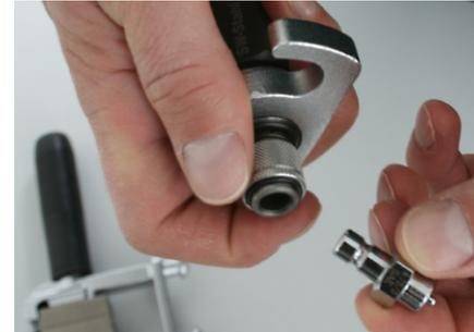
Nehmen Sie die Druckspindel (3) und stecken das für die entsprechende Bördelung notwendige Druckstück (9 - 13) ein.
